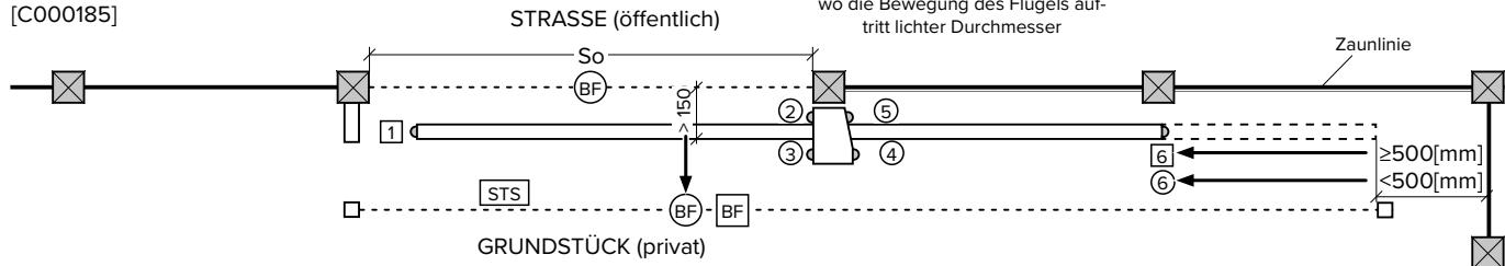
[C000138] Richtlinien für die montage eines schiebetors bei dem lichten durchmesser der füllung in der umzäunung von >40[mm], wobei eine möglichkeit besteht, das tor von der umzäunungslinie wegschieben
