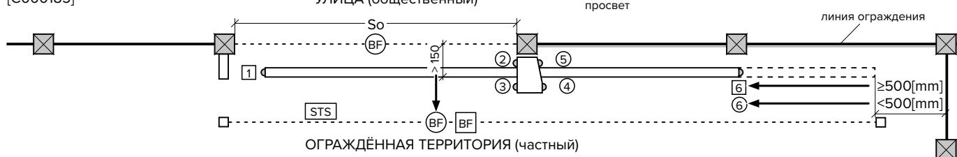
[C000138] Указания, касающиеся монтажа откатных ворот при проёме в ограждении >40[мм] с возможностью отодвинуть ворота от линии ограждения
