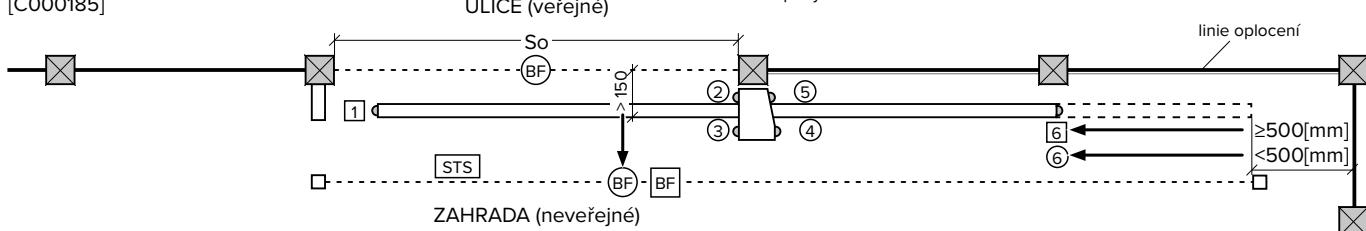
[C000138] Směrnice pro montáž posuvných vrat o světlosti vyplnění oplocení >40 [mm] s možností přesunutí vrat od linie oplocení
