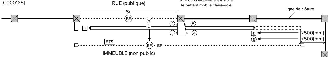
[C000138] Lignes directrices pour le montage d'une porte coulissante avec claire-voie de plus de 40 [mm] dans la clôture, avec possibilité de réaliser un écart entre la porte et la ligne de clôture
