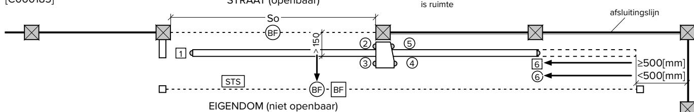
[C000138] Richtlijnen voor het monteren van een schuifpoort met een ruimte in de invulling van de afsluiting >40[mm] met de mogelijkheid om de poort van de afsluitingslijn weg te schuiven
