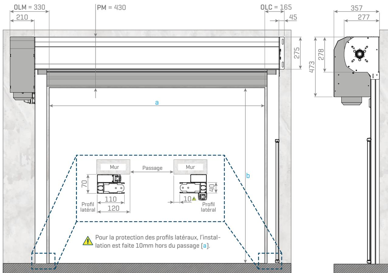
Légende: OLM - Écoinçon côté moteur; OLC - Ecoinçon côté opposé; PM - Linteau minimale
