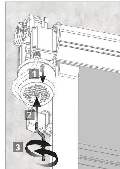
Pour ouvrir ou fermer la porte manuellement, il suffit de tirer et de maintenir le levier de déverrouillage et d'insérer la manivelle pour tourner la vis installée dessous le moteur (voir image).
