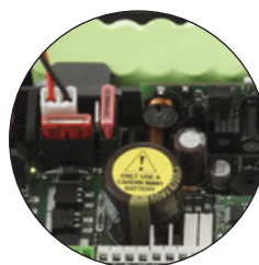
BATTERIES DE SECOURS CC242ETOPCB ET CC242EXTOPCB
