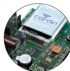
AUTO-PROGRAMMATION AU MOYEN D'UN AFFICHEUR LCD GRAPHIQUE
