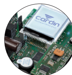
AUTO-PROGRAMMATION AU MOYEN D'UN AFFICHEUR LCD GRAPHIQUE
