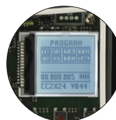
AUTO-PROGRAMMATION AU MOYEN D'UN AFFICHEUR LCD GRAPHIQUE
