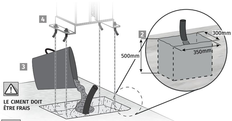
**!** Pour un fonctionnement correct de l'automatisme, il faut faire attention aux dimensions mentionnées dans l'image. **Laissez un espace libre de 200 mm sur le côté de la porte de chaque fût, afin de pouvoir ouvrir la porte chaque fois que nécessaire.**
