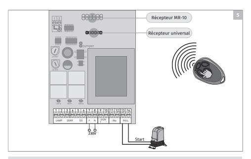
En cas d'avoir un récepteur universel avec mémoire externe, il sera possible de connecter directement à une nouvelle centrale Motorline, en utilisant un interface MR-12 pour connexion du récepteur universel à notre centrale Motorline.
