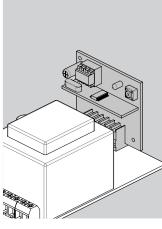
Le récepteur MR-10 a une capacité pour mémoriser 30 télécommandes. Pour ajouter une nouvelle télécommande:
