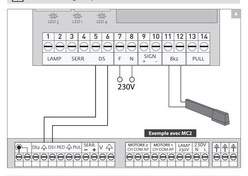
Si une centrale (par exemple MC2) n'est pas préparé pour recevoir des barres palpeuses de sécurité du type résistif 8k2, avec la MR-12 il sera possible de faire LA connexion des barres palpeuses 8k2 du type résistif et transforme en contact NC.
