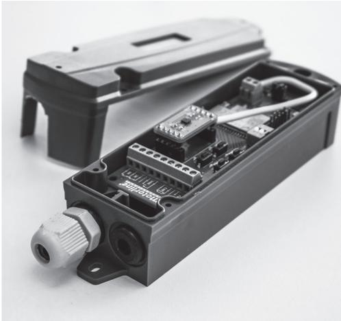
Le MX14 est un émetteur qui communique sans fil avec le récepteur MR14, jusqu'à 50m à l'air libre, alimenté par piles ou piles rechargeables par panneau solaire. Il permet la connexion d'une bande de sécurité 8k2, d'un capteur optique et d'un dispositif de sécurité à contact sec, ou l'utilisation d'un accéléromètre.
